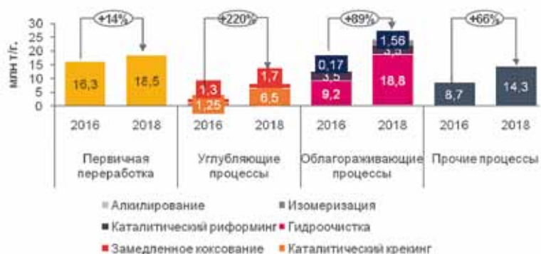
Рисунок 7 – Изменение мощностей установок первичной и вторичной переработки нефти на трех крупнейших НПЗ РК по результатам их модернизации
